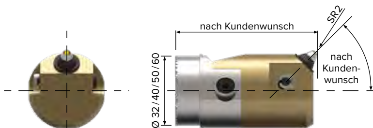
Schwingungsgedämpfte Bohrstange Ø 32 / 40 / 50 / 60
